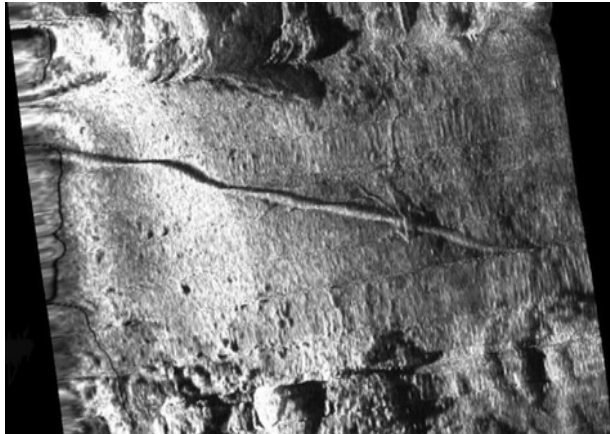
▲ Fig. 5: Seguimiento por sonda de un conducto submarino. Se aprecia la zona explanada.
