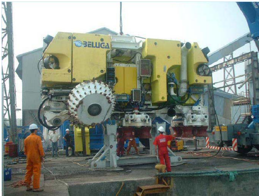
▲ Figura 58: ROV para tareas de explanación submarinas.
