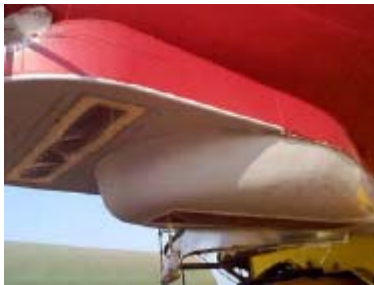
▲ Figura 23: Sonda multihaz montada sobre el casco del buque Le Suroît , de la flota de IFREMER .
