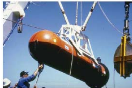
▲ Figura 24: Sonda lateral en dispositivo deep-tow , para ser arrastrado. El peso es de unas 2 toneladas, y puede requerir hasta 9 Km de cable coaxial.
